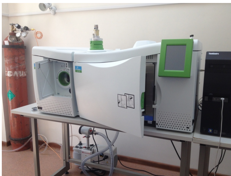
Рис.2 - Анализ нефти и фракции нефти до 60 °С методом хромато-масс-спектрометрии
