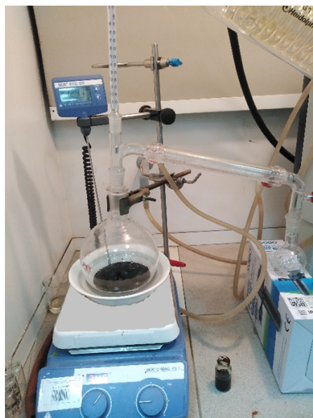
Рис.1 - Перегонка нефти под атмосферным давлением
