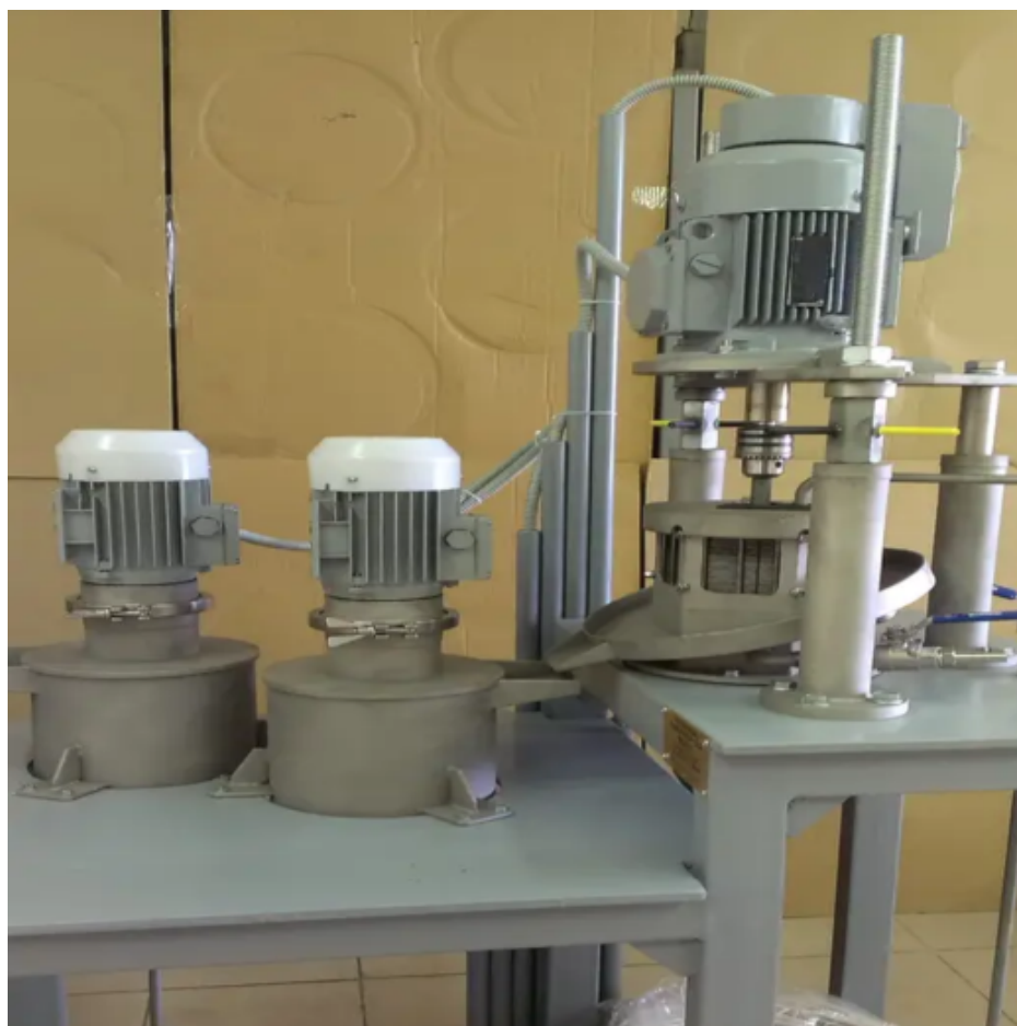
Рис. 2 – Внешний вид бисерной мельницы МБЛ – 1 для сверхтонкого измельчения
