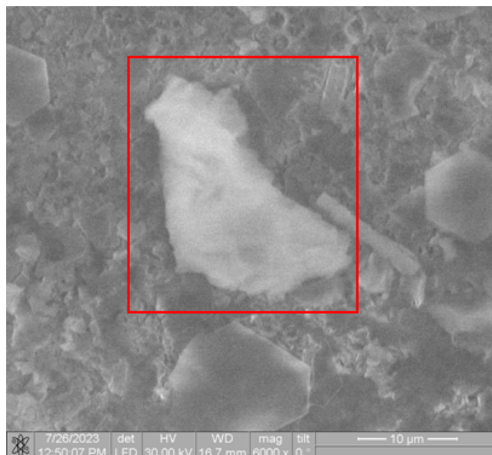
Рис. 4 – СЭМ снимок образца Bu[6] + ДА, где красным квадратом выделен конгломерат ансамбля молекул Bu[6]
