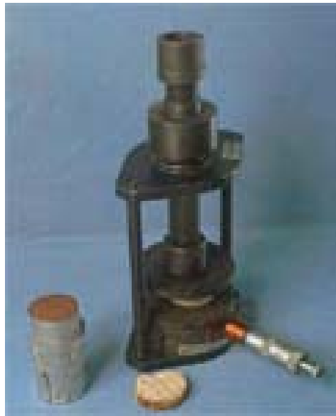
Рис. 1 - Моделирование прибором трещиноватости горных пород
