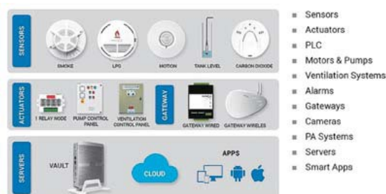
Рис. 3 - Элементы системы пожарной безопасности на основе IoT
