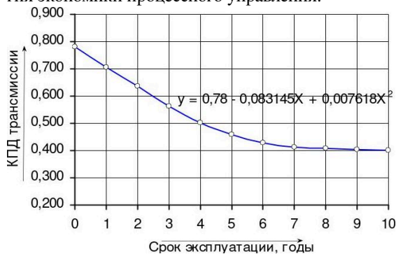
Рис. 2 - Зависимость КПД двигателя автосамосвала от срока эксплуатации
