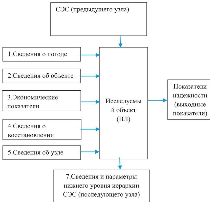
Рис.1. Структурная схема расчета узловой надежности.
