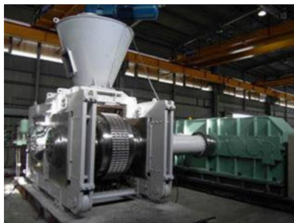
**Fig. 2 - Coal briquetting plants**
