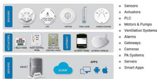
Рис. 3 - Элементы системы пожарной безопасности на основе IoT
