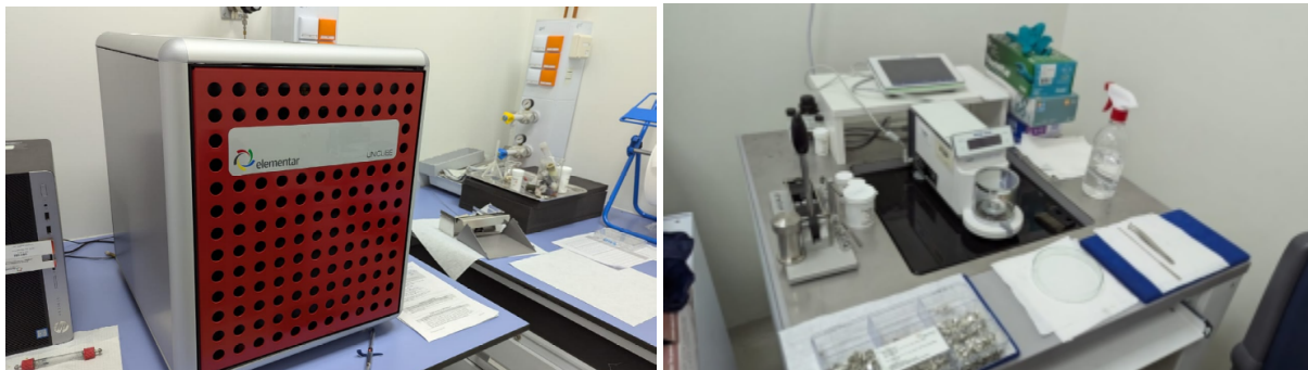
Рис. 3 - Элементный анализатор CHNS-O UNICUBE производства компании «Elementar Analysensysteme GmbH» (Германия) для определения элементного состава бурых углей, золы и гуминовой кислоты
