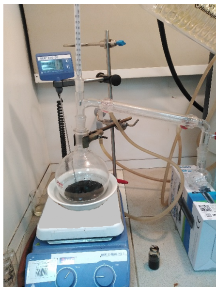
Рис.1 - Перегонка нефти под атмосферным давлением
