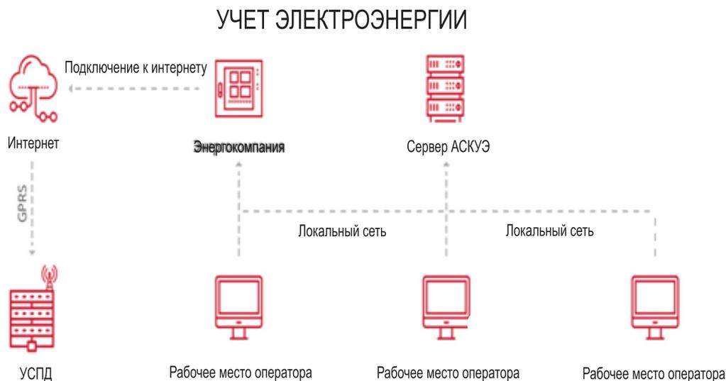
**Рис.1 – Схема автоматизированной системы управления учета и контролем энергопотребления электроэнергией производственным объектом**
