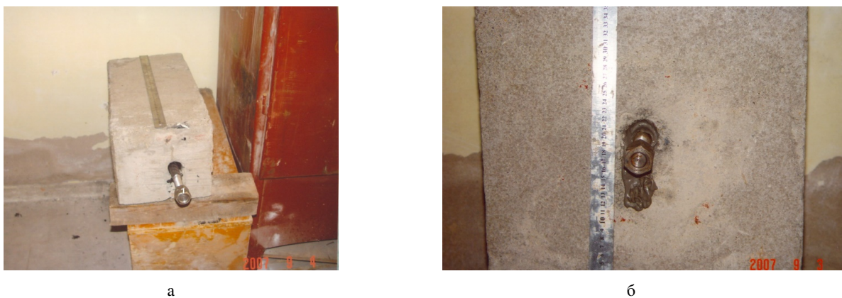
Рис. 8 - Определение несущей способности на испытательном стенде ампул АМК-М (а) и АЦД (б)
