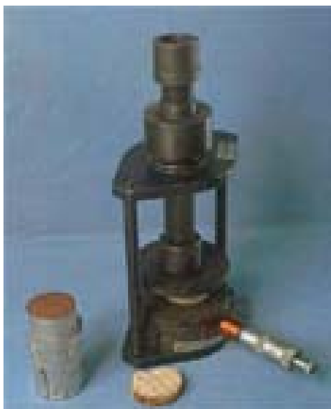
Рис. 1 - Моделирование прибором трещиноватости горных пород
