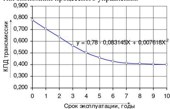
Рис. 2 - Зависимость КПД двигателя автосамосвала от срока эксплуатации
